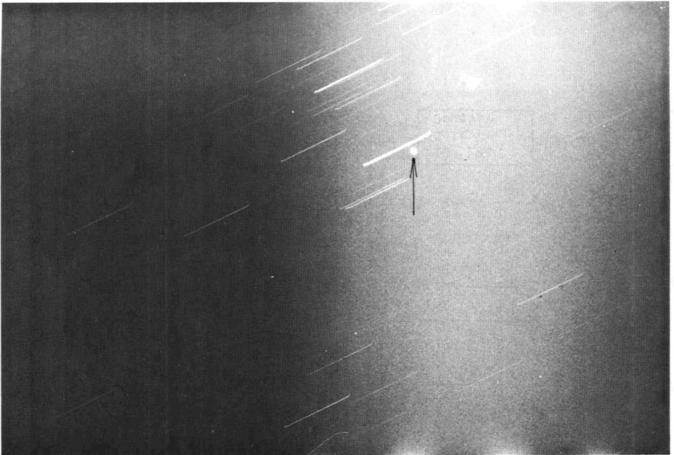
Fig 4 改造した3軸トラッキングベデスタルによる衛星追跡 の例。衛星は風船衛星パジ奥斯 タイム露出：30秒
