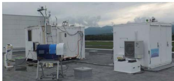
図1 滝川スカイパークに設置した北大低温研の3D-CDL（右のコンテナ）と各種観測装置
