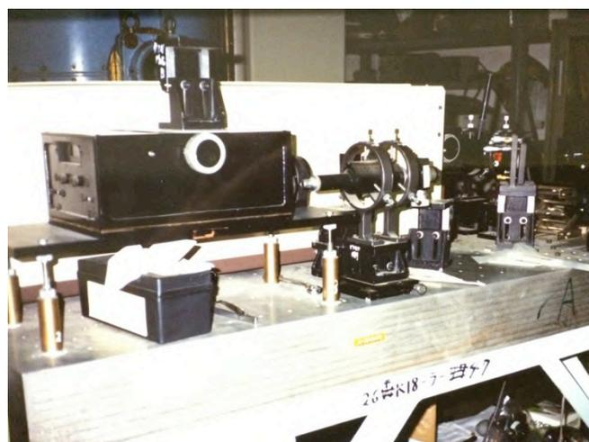
写真 1 1991 年頃に稼働していた信州大学 Na ライダー。電波研（情報通信研究機構の前身）からもらってきた口径 1m 望遠鏡、南極で越冬した色素レーザー、受信系や波長同調確認装置（分光器もどこからかのもらい物）などが見える。レンズ・ミラーホルダなどは手作り自作、定盤のネジ穴開けもやる、台座の電気溶接なども覚えた。
