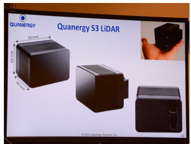
Fig.4 光フェーズドアレイ・ライダーの外観。 大きさ: 90mm x 60mm x 60mm
